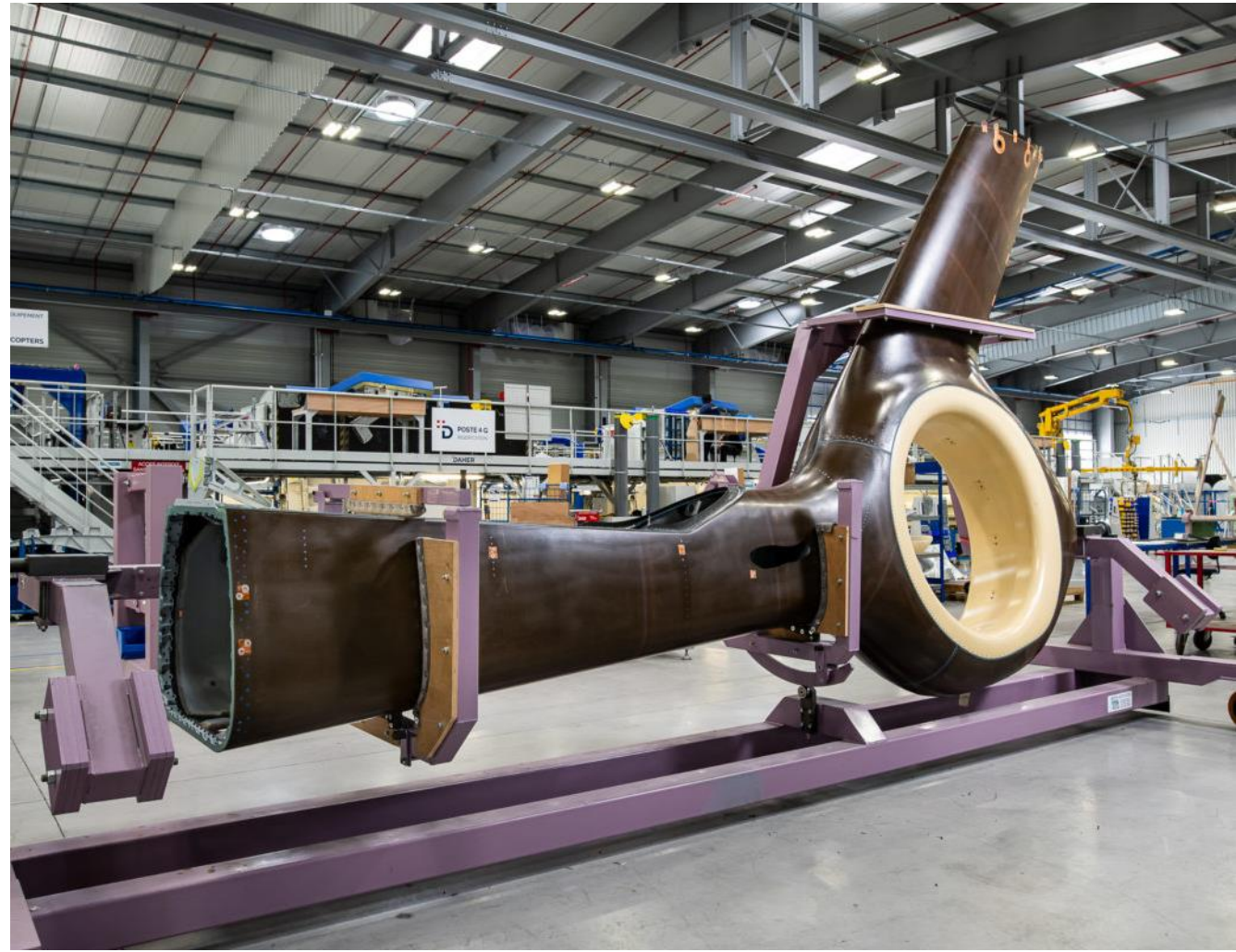
Structure de queue en composites de l'hélicoptère H160 d'Airbus
